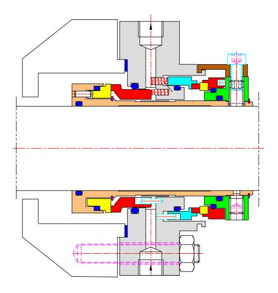
90 SERIES MULTI SPRINGS BALANCED SLURRY MECHANICAL SEAL
